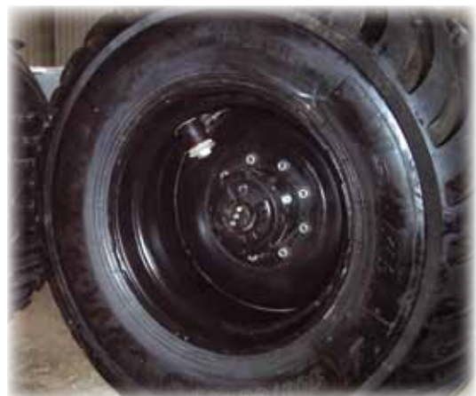
Der hydraulische Radnabenantrieb über Planetengetriebe liefert eine äusserst hohe Antriebskraft. Die Antriebseinheit ist am hinteren Räderpaar des Boogies angebracht. Bei eingeschaltetem Antrieb hat der Hydraulikmotor einen automatischen Freilauf bis zu 40km/Std mit LS-system.
