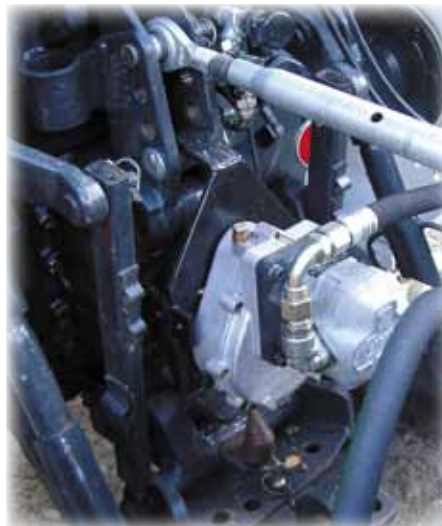
Die Pumpe/Getriebeeinheit der Maschine wird direkt an die Abtriebswelle des Traktors angeschlossen. Dies ergibt geringeres Gewicht und kompaktere Montage.
