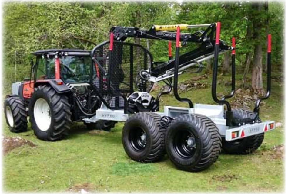
Greiflader Cranab FC53DT mit max. Länge von 8,5 m.
