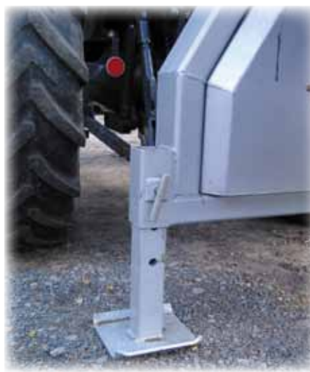
Manuell verstellbare Stützbeine mit drei verschiedenen Höhenlagen.
