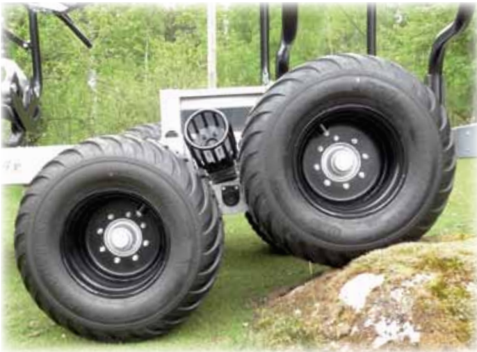
22° Boogie-Pendelachse für optimale Fahreigenschaften in schwierigem Gelände.
