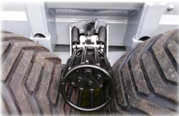
Auf Hypro HV14 können Sie zwischen Robsonbetrieb oder Hydraulikmotorbetrieb über Planetengetriebe wählen. HYPRO 4WD Robsonbetrieb liefert eine äusserst hohe Antriebskraft und die Betriebseinheit hat ein sehr geschützten Platz.
