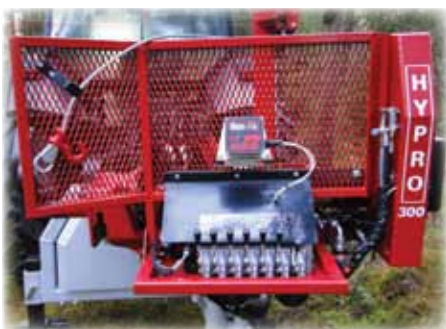
Das Bedienpult der Maschine mit einfach zu bedienenden Handhebeln ist in bequemer Arbeitshöhe angebracht. Hier besteht die Möglichkeit zur individuellen Einstellung der Geschwindigkeit für sämtliche Funktionen. Die Anzeige des Messsystems ist übersichtlich und leicht leserlich angeordnet.
