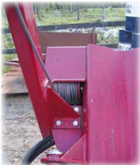
Hydraulische Winde im Rahmen der Maschine. Bedienung über Handhebel oder Funk. Beim Signal ein / aus wird das Seil zugeführt und immer automatisch am Stopp verriegelt.
